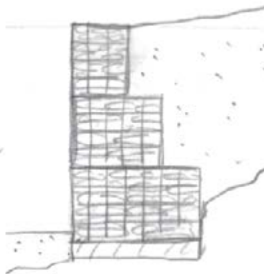
Mur de soutènement en gabion
