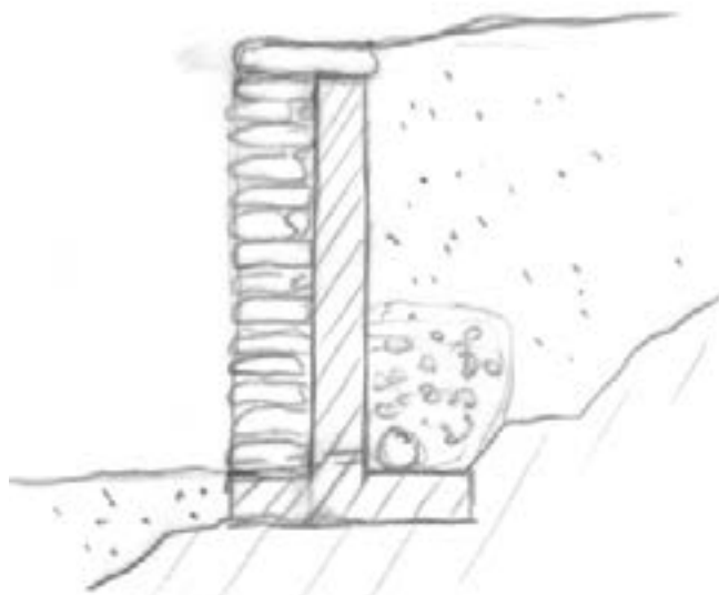
Mur de soutènement en béton avec drain, parement en pierre sèche - pour grandes hauteurs
