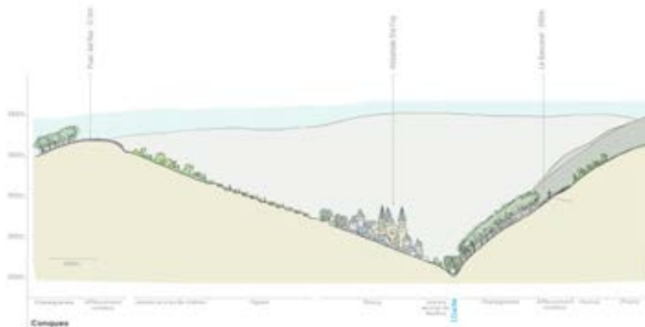
Coupe schématique sur la vallée de l'Ouche- Implantation du village de Conques, en partie basse du versant - Terrasses de vignes au dessus du village Anciennes terrasses en contre-bas jusqu'à l'Ouche, en partie enfrichées
