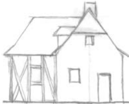
Pans de bois + enduit à la chaux
