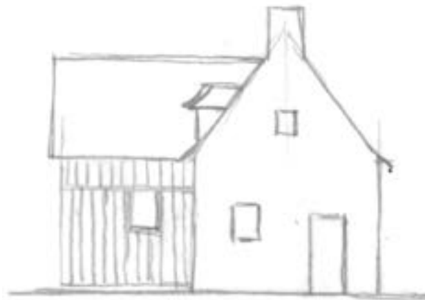
Bardage vertical + couvre-joint
